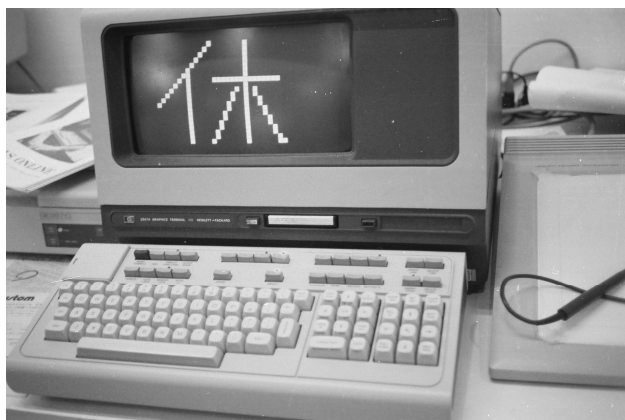
図1 構造検索に用いられた HP2647A, 画面の下に磁気テープ・カセットが見え、右に作図用タブレットも写っている (1982年)
