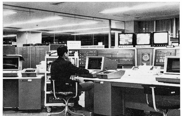
図1 HITAC 8800/8700 システムコンソール<sup>1)</sup>
