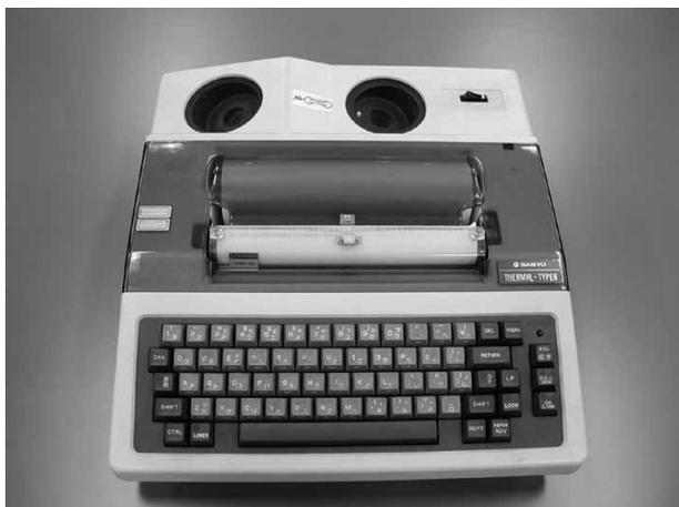
写真2 漢字端末機 Sanyo Thermal-Type, かなで検索し、漢字交じりで出力できた（鶴見大学 原田智子氏所有）
