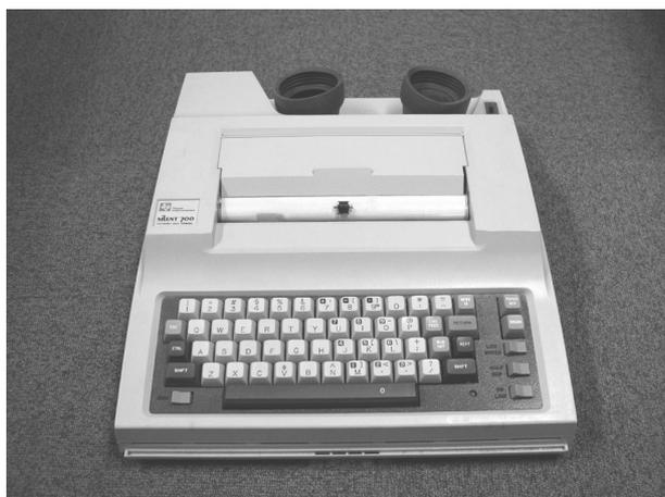
写真1 Silent 700型音響カプラー付き端末機（これは米国仕様で英字のみだが、英字とカタカナが入出力できる機種も販売された、筆者所有）
